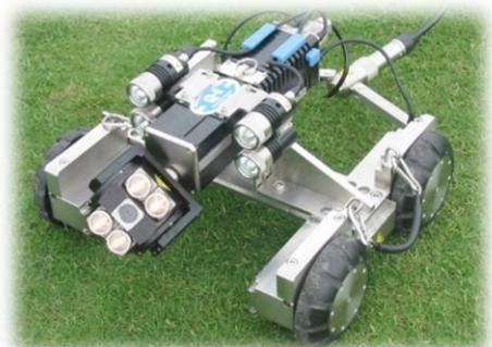
下水道管渠 TV カメラ (Q-I PV-2300)
